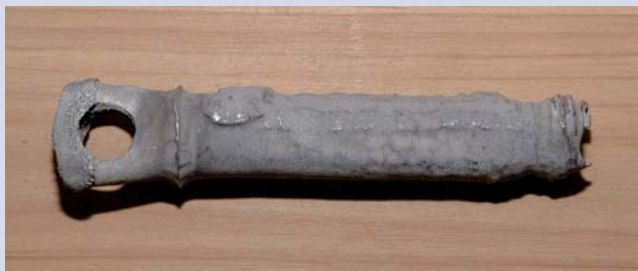
Rustfri bolt (4301) efter et længere ophold i stærk bejdsesyre (salpetersyre-flussyre). Bemærk, at korrosionstabet er ganske ensartet og over det hele, og at mængden af tabt metal er ganske stor. Trods det imponerende materialetab er der endnu ikke sket gennemtæring.
