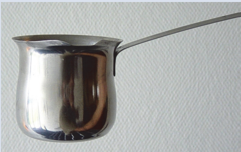
Ferritiskt rostfritt stål kan med fördel användas till produkter med tunt gods, stora materialomkostnader och enkel förärbetning. Denna kanna är i 4016 (AISI 430), ett ofta använt material inom catering. I övrigt ett utmärkt exempel på att man kan djupdra ferritiskt rostfritt stål.
