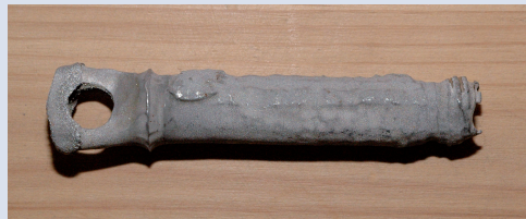
Rostfri bult, 4301, med korrosionsangrepp efter tre månader i betsyra (salpetersyra-fluorvätesyra). Observera att korrosionen är jämnt fördelad över ytan och att mängden förlorad metall är ganska hög. Trots de imponerande materiella förlusterna har ännu inte genomfrätning skett.
