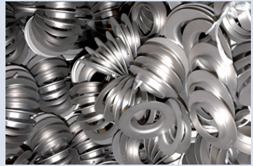
De austenitiska stålens stora töjning (> 45 %) gör att de är mycket duktila och lätta att forma. Dessa pressade kragar är tillverkade av 4404.
